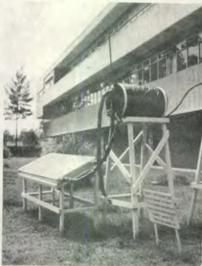
FIGURA 25 Ilustración del Sistema Solar en pleno funcionamiento y completamente aislado.
