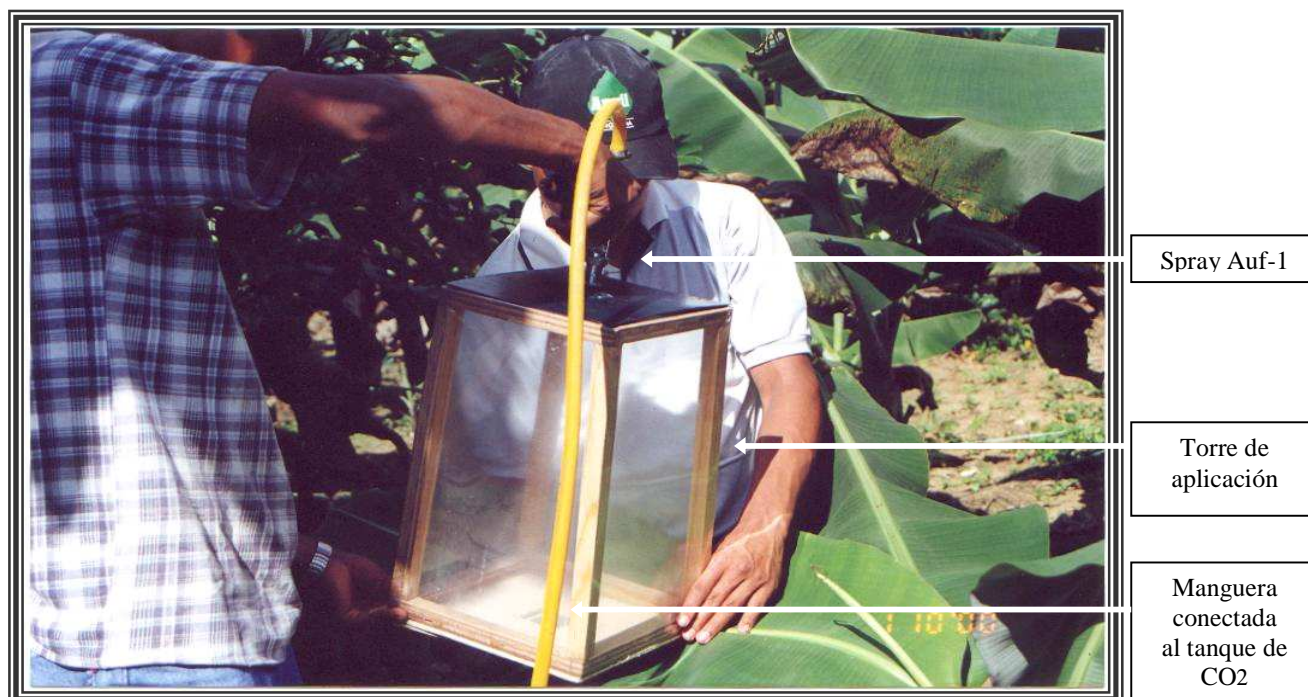
Fig 4. Método de aplicación (Single Leaf Test) para la evaluación de fungicidas sistémicos, finca Villa Fénix, Morales Izabal, 10/1/2000
