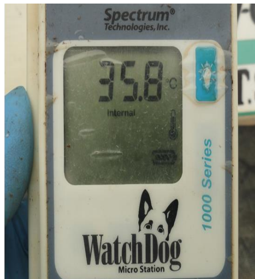
Figura 26A. Sensor de temperatura, humedad relativa, conductividad eléctrica, registrando 35.8 °C en el invernadero.
