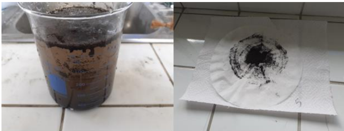
Figura 7A. proceso de extracción de quistes por flotación, a: inmersión de suelo en agua para flotación de quistes, b. filtrado de sobrenadante y secado de muestra.
