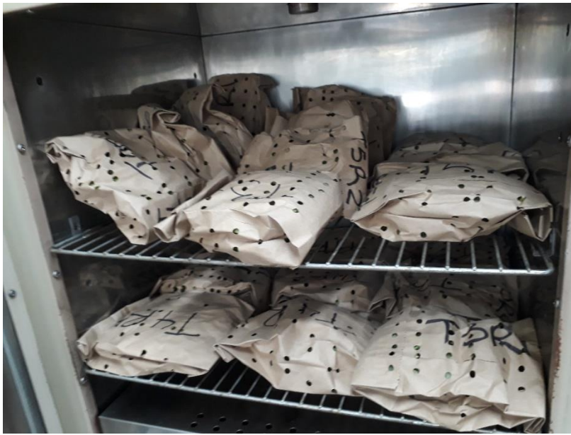
Figura 20A. Muestras secándose en horno de FAUSAC.
