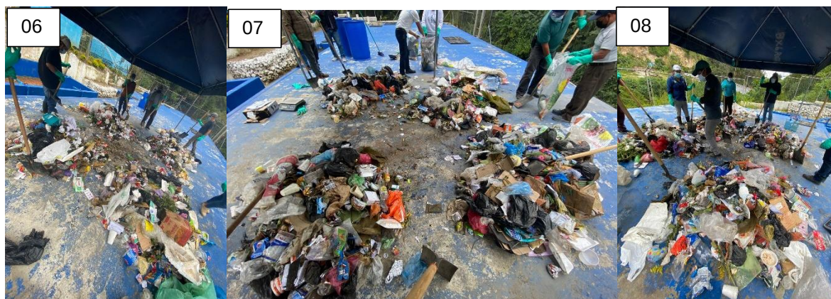
Figura 37. Método del cuarteo.
