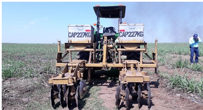
Figura 10. Control mecánico por medio del implemento ferticultivo.
